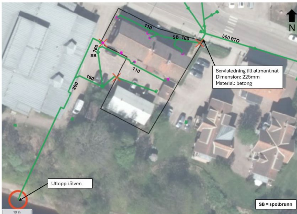
Figur 8. Kartan visar fastighetens befintliga dagvattensystem och hur det hör ihop med dagvattennät på angränsande fastigheter. Källa: Dagvattenutredning, WSP 2025-10-30.
