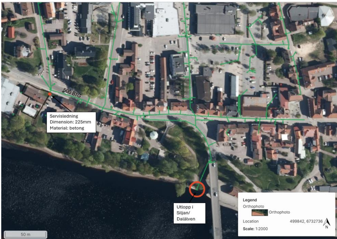
Figur 12. Befintligt kommunalt ledningsnät från planområdet till utlopp i recipient. Huvudledningar är markerade med gröna linjer, anslutningspunkt till Udde 5 är markerad med röd prick, röd cirkel markerar utloppet till recipient. Gröna prickar inom och intill planområdet markerar dagvattenbrunnar. Svart linje markerar planområdet.
