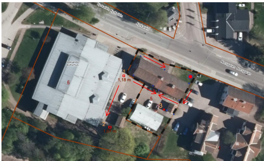
Figur 14. Röda rektanglar (1, 2 och 3) visar dagvattenbrunnar som finns i området. Röd cirkeln visar fjärrvärmebrunn. Blåa prickar markerar stuprör. De röda pilarna visar marklutning.
