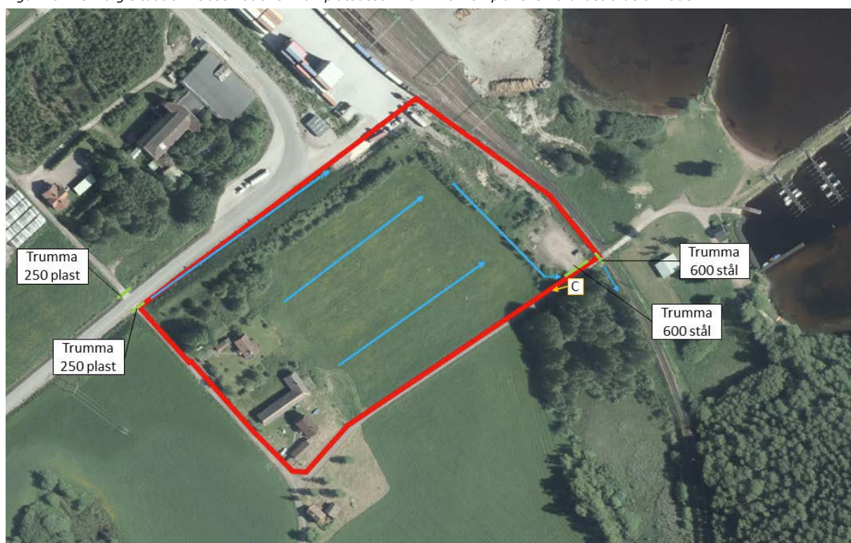
Figur 11: Befintlig situation. Observationer från platsbesök 2022-10-18 i planens sydöstra delområde.
